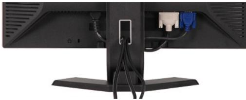
Después de conectar al monitor y al equipo todos los cables necesarios, (consulte la sección "[Conexión de los cables](#)" para la conexión del cableado) use la guía de cables para ordenar cuidadosamente todos los cables como se muestra arriba.
