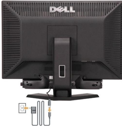
1. Desde la parte trasera del monitor, acople la barra de sonido alineando las dos ranuras con las dos pestañas de la parte trasera e inferior del monitor.
